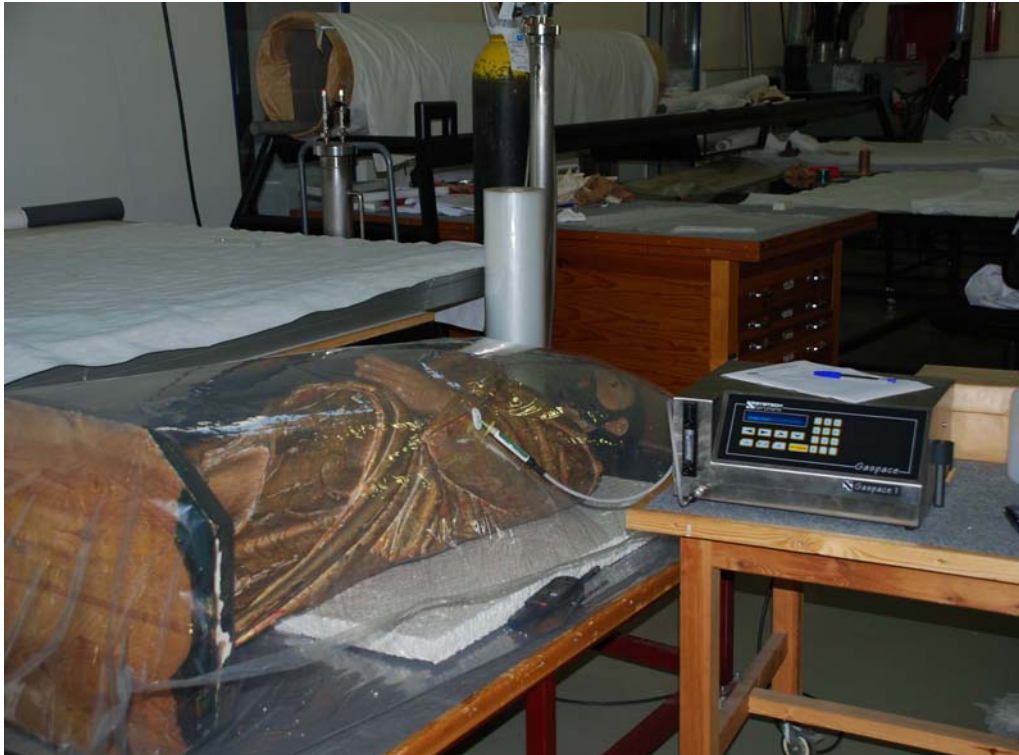
Figura 5. Tratamiento de desinsectación con gas argón (Foto: Víctor Menguiano).
